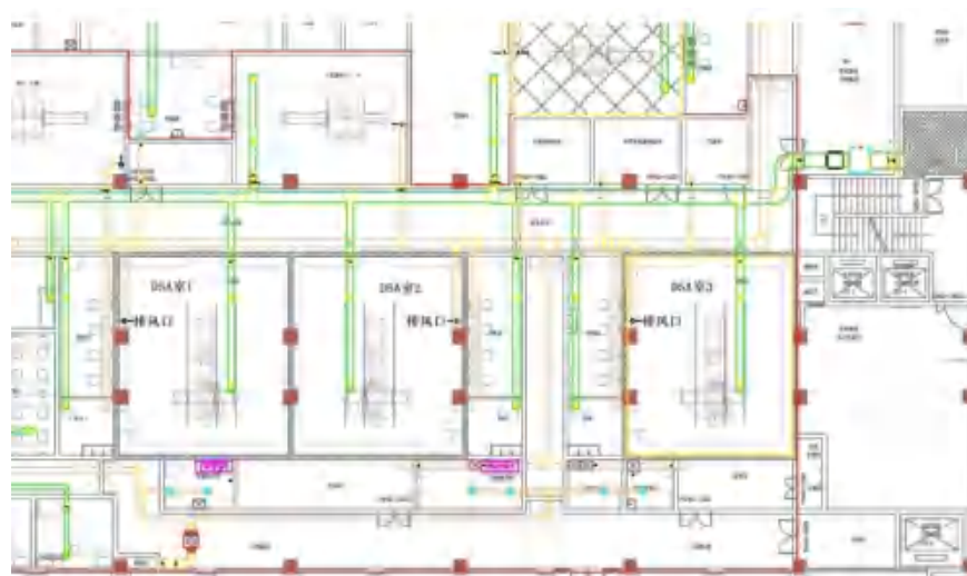
图 3-4 介入科 DSA 机房通风设置示意图
