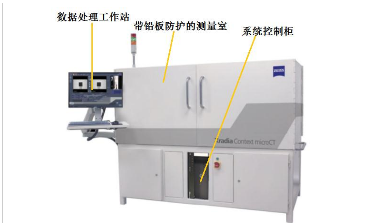
图2-7 工业CT设备外观结构图
