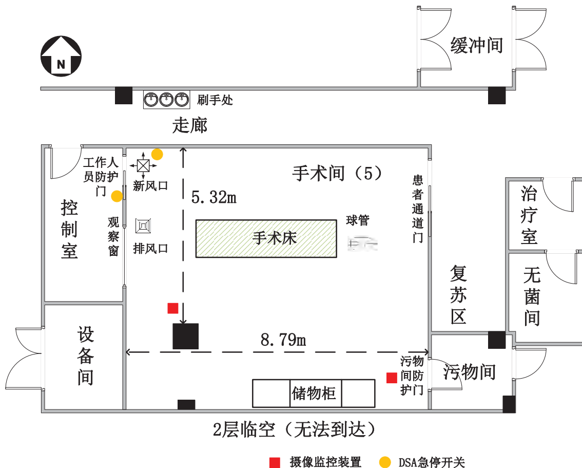
图3-1 项目机房四周平面布局图
